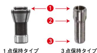
ロータリーバーを3点で保持することにより、軸ブレをなくし、騒音を低減。ロータリーバーを長持ちさせランニングコストを抑えます。
