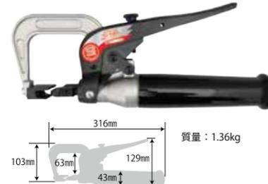
ヘミング加工の前工程として、パネル表面の"ヒズミ"を防ぐために、アウターパネルを1段階・2段階・3段階と、約50°くらいまで徐々に曲げていきます。
