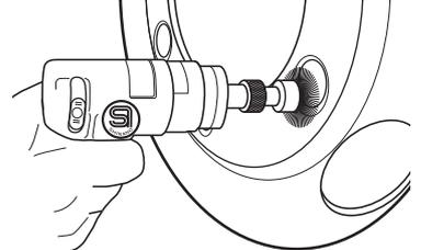
ホイール部のナットが当たる座面部に対し、座面ブラシを本体にセットし座面部に当て、サビ落とし作業を行います。
