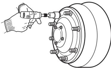
ハブボルトのサイズに合ったクリーナーケースCPを本体にセットしボルトに当て右ネジは右回転、左ネジは左回転でブラシを回転させる。ドラムにクリーナーケースが当たる前に回転を止めて、逆回転に切り替えボルトからブラシを抜きます。汚れ等が、取れていない場合は、2~3回繰り返し作業を行ってください。
