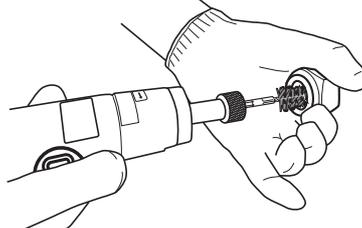
アウターナット、インナーナットの内面のクリーナー作業。
