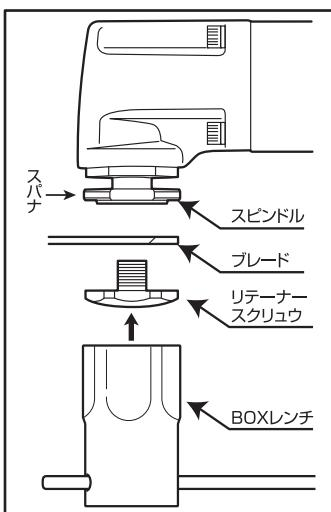
②スピンドルの六角凸部にブレードの12角穴を使う角度に合わせて、きれいにはめ込んで下さい。
