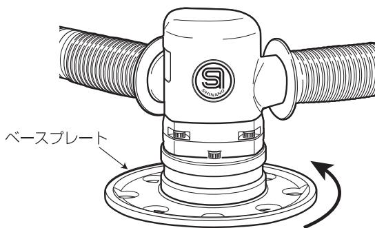
※十分に緩めないと、内部ネジが破損する恐れがあります。
