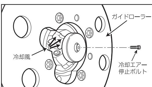
●チップを長持ちさせ、切粉の溶着を防ぐため、冷却風が噴射します。
